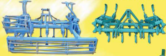
Subsoladores con bulldozer y rulo
